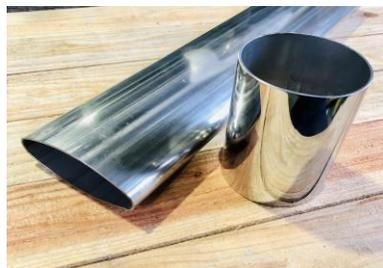
成型が難しいと判断し、外注に頼っていたΦ89.1のパイプを、15年ぶりに我が社にて成型。
